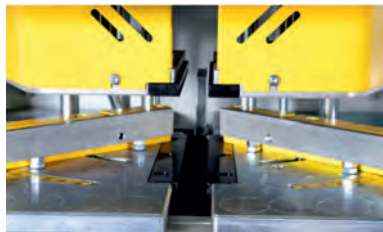
Bıçaklar ve ayarlanabilir kalıplar Blades and adjustable molds
