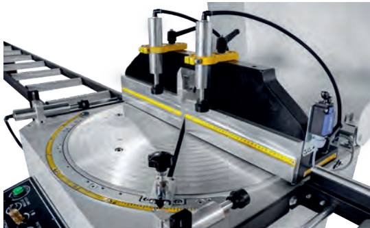
ÖNE ARKAYA HAREKETLİ SİPER FRONT-REAR MOVING GUARD
