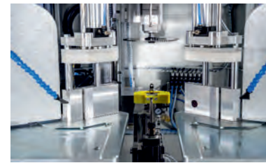
Profili otomatik tanıma Automatic recognition of profile
