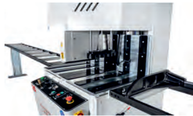
Sağ sol 3mt makaralı konveyör Right left 3mt roller conveyor
