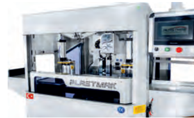
Otomatik kapanan güvenlik kapağı Automatic closing safety cover
