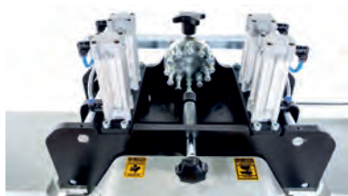
12 farklı çıta için çark sistemi Wheel system for 12 different strap
